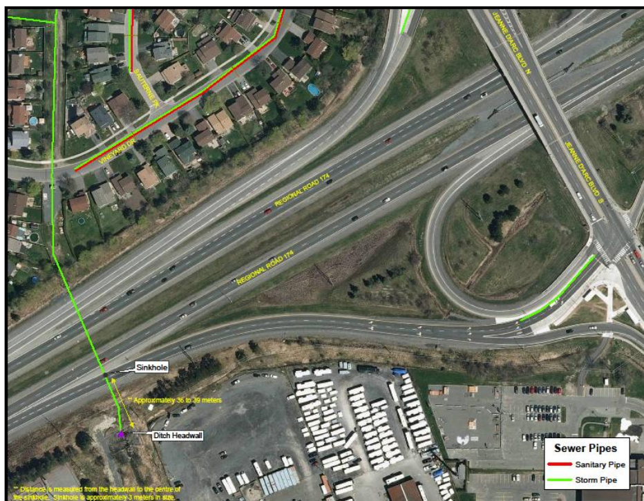
Figure 3 – conduite d'égout pluvial de 3,6 mètres de diamètre
